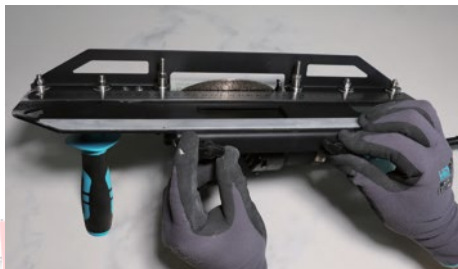
Korak 2. Okrenite zavrtnje za podešavanje u smeru kazaljke na satu/u smeru suprotnom od kazaljke na satu, držite oba zavrtnja podešena. Okrenite u pravcu kazaljke na satu da biste dobili tanju reznju ivicu a u smeru suprotnom od kazaljke na satu da biste dobili deblju reznju ivicu
