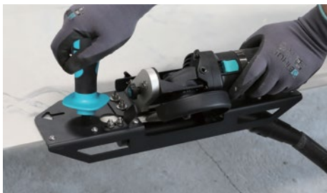
Korak 3. Krećite se ravnomerno napred da biste napravili savršeno iskošenje.
