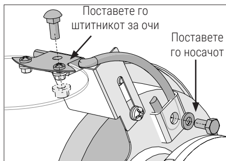
Слика 2. Постолје инсталирано и поставено во близина на брусното тркало
