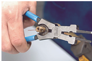
postavljanje i demontaža unutrašnje čaure gorionika
